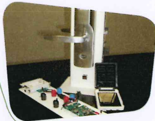
● serrure biométrique avec chargeur solaire
